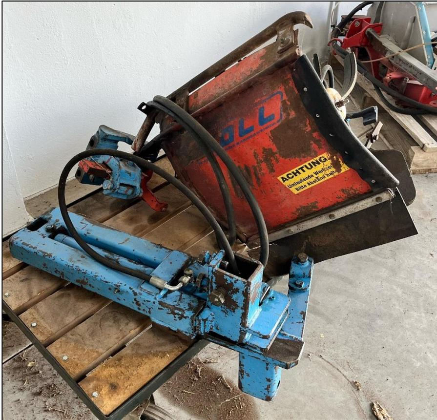
Le lame intercept sert à couper les mauvaises herbes en-dessous des plants de vigne. Il est équipé d'un palpeur sensible et réglable.
