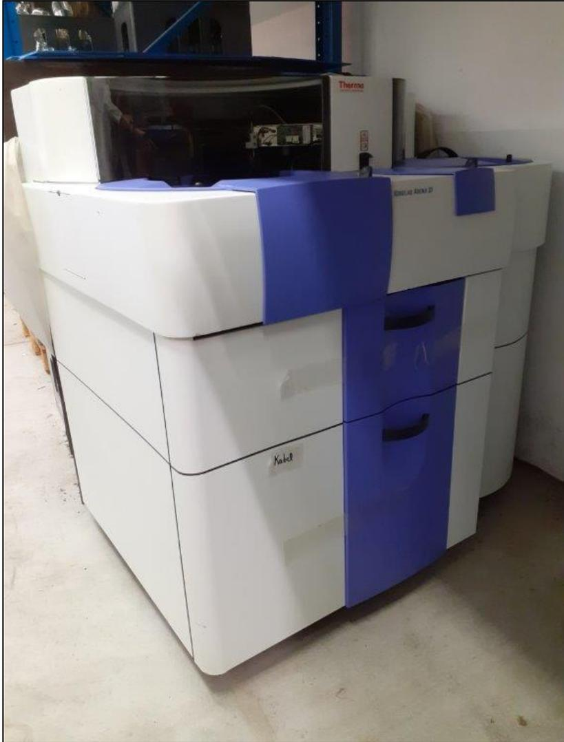
L'analyseur séquentiel est un système photométrique automatisé à accès aléatoire entièrement ouvert, bien adapté à l'analyse de produits et au contrôle qualité dans le secteur des aliments et des boissons, ainsi que dans d'autres processus industriels. Les applications couvrent les méthodes pour le vin, les jus, la bière, le lait et le miel.
