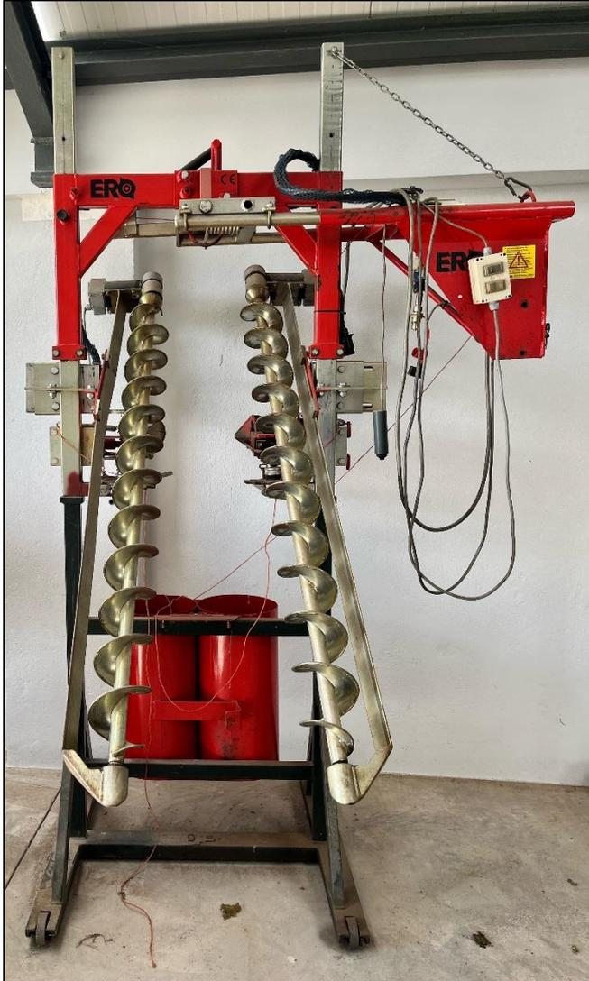
La palisseuse sert à redresser le feuillage dans les rangés de vigne. Pour ce besoin des vis sans fin remontent le feuillage, qui ensuite est maintenu par un fil dans lequel des agraffes sont placées. Elle dispose également d'un système de freinage des fils, afin de faciliter la fixation en fin de rang.
