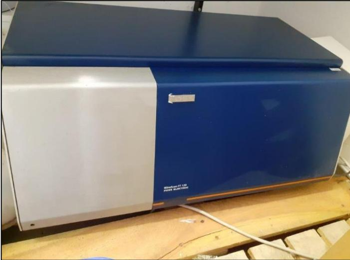
Le Winescan permet des analyses très rapides et précises. Les calibrations sont immédiatement utilisables et permettent d'obtenir simultanément la plupart des paramètres de la qualité du vin.
