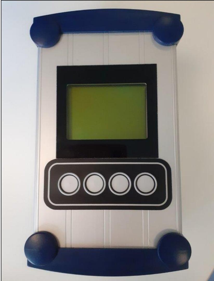
Le trace LCD Fibox 3 est un oxymètre à fibre optique autonome. Il est compensé en température et utilisé avec des capteurs d'oxygène basés sur une fibre optique de 2 mm. Il est portable et dispose d'une batterie rechargeable et d'un enregistreur de données intégré.
